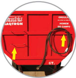
Escada e suporte para mangueiras
