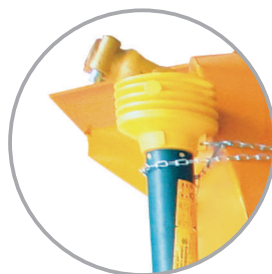
Detalhes: Cardan com proteção
