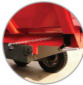
Sistema de abertura da tampa
