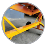
Reforço no cavalete
