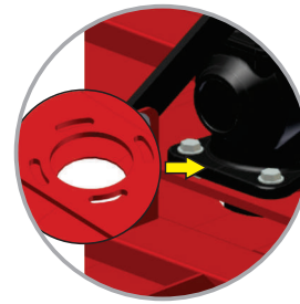
Ajuste da caixa para deslocamento lateral
