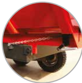
Sistema de abertura da tampa
