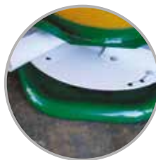
Disco e pás com pintura eletrostática ou inox (Opcional)
