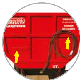
Escada e suporte para mangueiras
