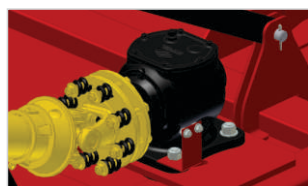
Cardan con embreaje (detalle interno)
