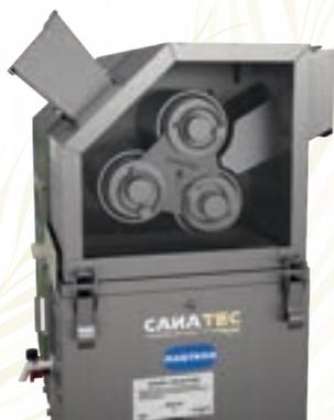
**Sensor de segurança na proteção dos rolos.** Conjunto fechado, evitando contato com insetos e carenagens em aço inoxidável polido.
